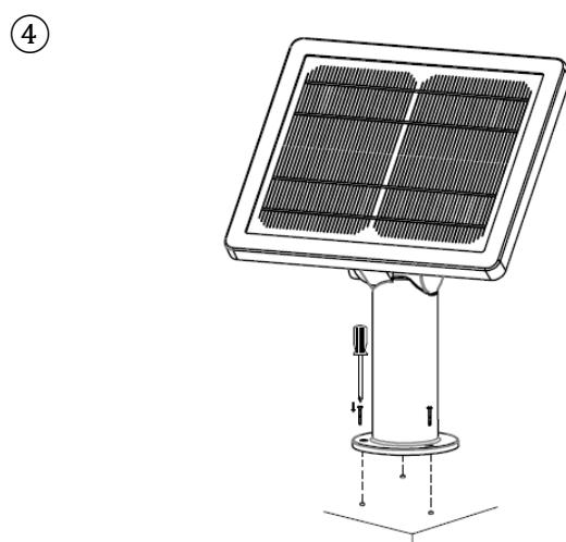
Installare il gruppo del pannello solare sulla superficie con 3 viti.
