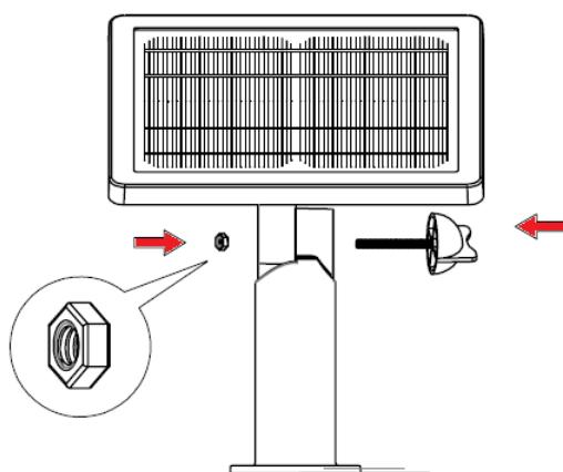
Fixez les pièces avec la vis papillon et l'écrou.
