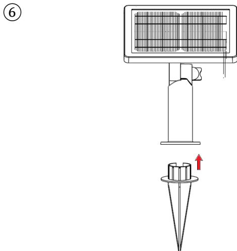
Le panneau solaire peut aussi être installé sur le sol en utilisant le pic.
