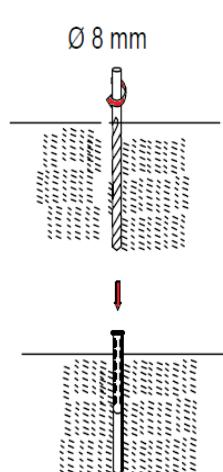
Percer 3 trous avec une mèche ( $\varnothing 8$  mm) sur la surface du béton, puis insérer les chevilles dans les trous.
