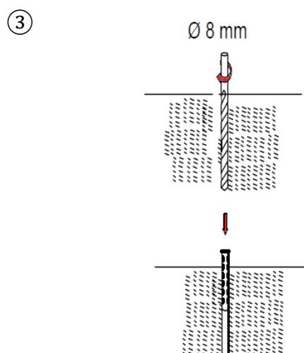
Apporre 3 fori con una punta da trapano ( $\varnothing 8\text{mm}$ ) sulla superficie in calcestruzzo, quindi inserire gli ancoraggi nei fori.
