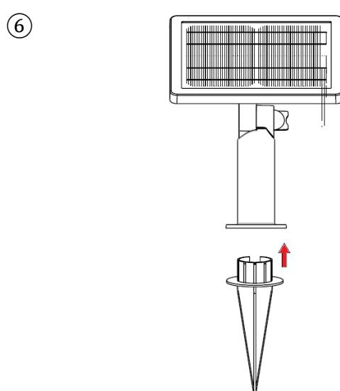
In alternativa, il pannello solare potrebbe essere installato a terra utilizzando un puntale.
