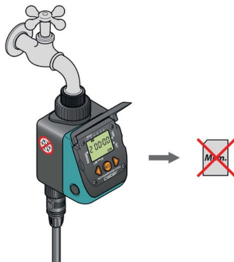
**RÉINITIALISER LE PROGRAMMATEUR.** Pour réinitialiser complètement le programmateur, maintenez enfoncées en même temps les deux flèches pendant au moins 10 secondes, jusqu'à ce que sur l'afficheur apparaisse 00:00.
