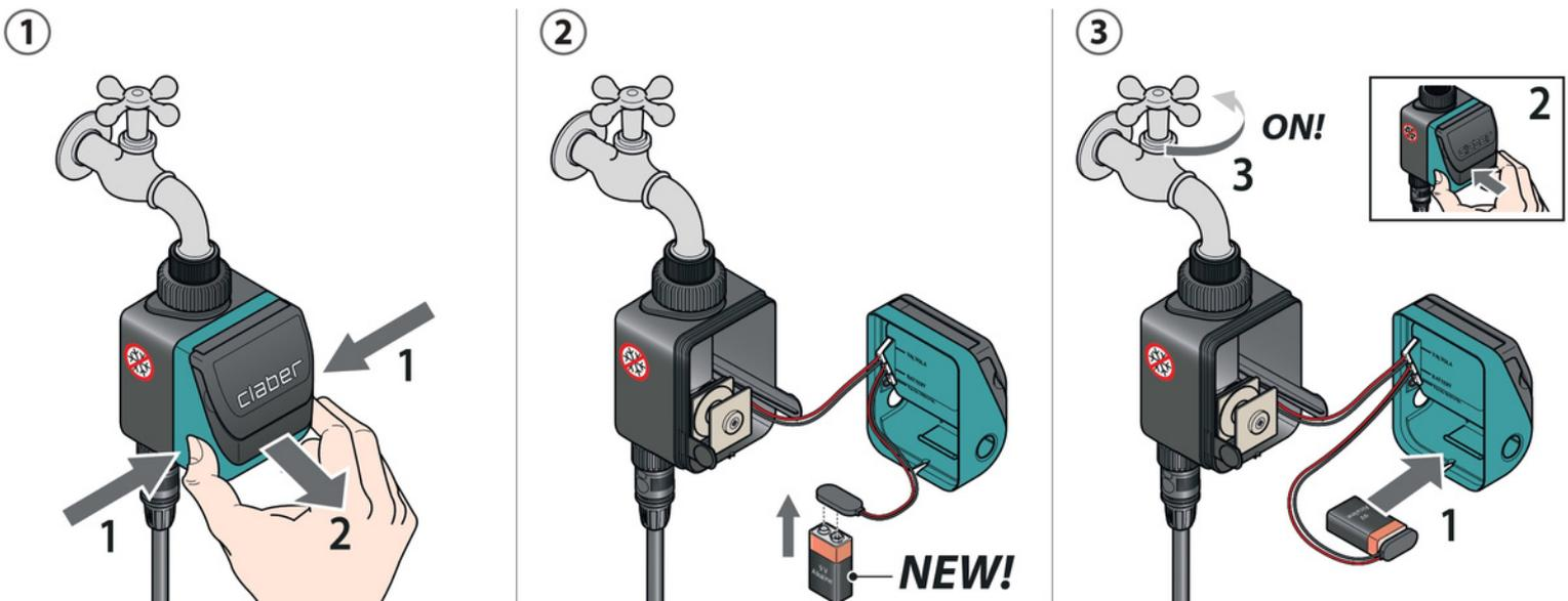
Dès que la pile est raccordée, l'afficheur s'allume, la vanne fait un cycle d'essai et le programmeur se règle sur l'horaire 00:00.
