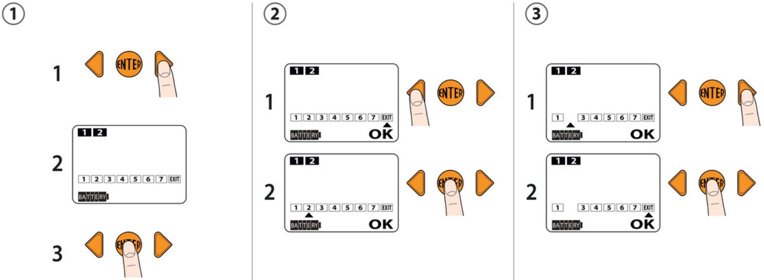
**PROGRAMMATION MANUELLE.** Avec la flèche droite, entrez dans la page de la programmation manuelle : fonction utile pour effectuer un ultérieur arrosage sans supprimer les programmes définis. Le programmeur règle automatiquement un temps d'arrosage de 15 minutes. Appuyez sur ENTER. Avec la flèche gauche, on active l'arrosage. Pour l'interrompre avant, appuyez sur la flèche droite, puis sur ENTER. Avec la flèche droite, on retourne à la page initiale (heure/jour).
