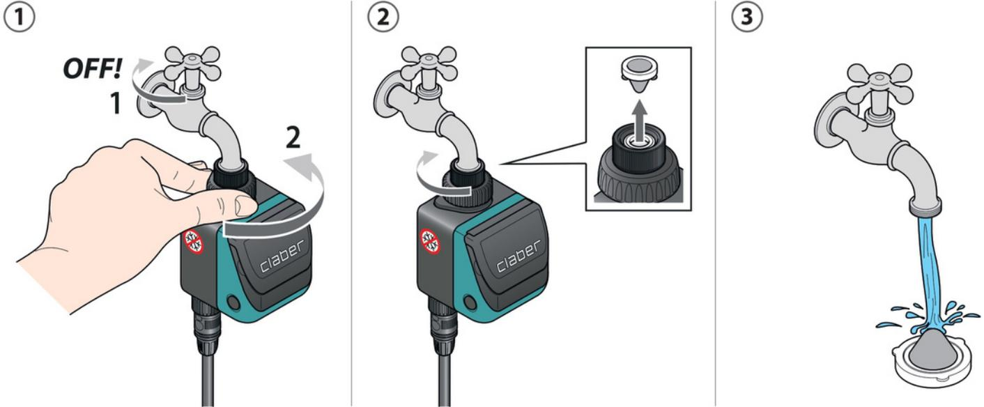
**NETTOYAGE ET ENTRETIEN.** En fin de saison, avant l'arrivée des gelées hivernales, débranchez le programmeur du robinet, retirez la pile et rangez-le dans un lieu à l'abri et non humide, où la température ne descend pas en dessous de 3°C.
