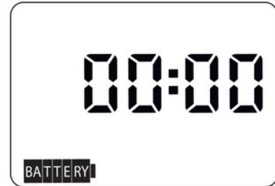
**PROGRAMMATION DE L'HEURE COURANTE.** En appuyant sur le bouton central ENTER, le message OK apparaît pour indiquer qu'il est possible de saisir l'heure. Appuyez sur une des flèches pour définir l'heure courante. En maintenant la flèche enfoncée, la programmation avance plus rapidement. Une fois l'heure saisie, appuyez sur ENTER pour confirmer.
