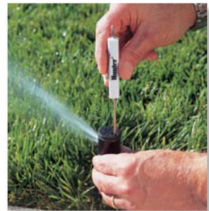
Le réglage de l'angle d'arrosage se fait facilement à l'aide d'un tournevis ou de la clé Hunter par le dessus de l'arroseur.
